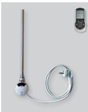
**Elektro-Heizstab ZENELF** mit Mediumtemperaturregler inkl. Fernbedienung 30 - 70° C (Oberflächentemperatur ca. 25 - 60° C), Timer für 2h Boostfunktion (max. Aufheizleistung auf 70 °C von der eingestellten Soll-Temperatur), Chrono-Modus mit individuellen Tagesprogrammen, Standbymodus, manuelle Einstellmöglichkeit, ECO Frostschutz, Kontrolllampe.
