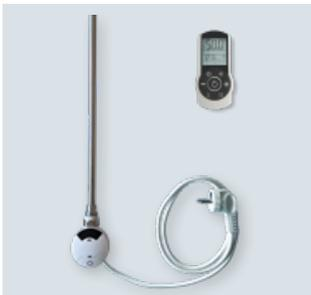
**Elektro-Heizstab ZENELF mit Mediumtemperaturregler inkl. Fernbedienung** 30 - 70° C (Oberflächentemperatur ca. 25 - 60° C), Timer für 2h Boostfunktion (max. Aufheizleistung auf 70 °C von der eingestellten Soll-Temperatur), Chrono-Modus mit individuellen Tagesprogrammen, Standbymodus, manuelle Einstellmöglichkeit, ECO Frostschutz, Kontrolllampe.
