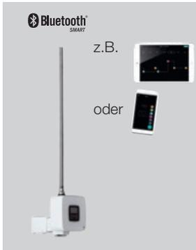
**Elektro-Heizstab ZEPELP mit Bluetooth Raumregelung Stone**, mit PTC-Element. Für Festanschluss, mit Schubrosette für verdeckten Elektroanschluss von hinten aus der Wand, Raumregler mit Ein-/ Aus-Schalter und digitaler Anzeige, steuerbar direkt am Raumregler oder mittels App über Bluetooth-Verbindung, individuell programmierbar.
