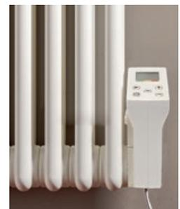
**Mera EK Elektrokomplett-Röhrenradiator** mit Wärmeträgerflüssigkeit gefüllt (Frostschutz bis -6 °C). Heizstab inklusive elektronischer Regelung mit Uhrenraumthermostat unten seitlich rechts montiert. Netzspannung 230 V / 50 Hz, Klasse II, IP24, mit ca. 1,2 m Anschlusskabel und Schuko-Stecker. Uhrenraumthermostat digital mit Wochenprogramm mit 3 voreingestellten Programmen sowie individuell programmierbarem Wochenprogramm, Frostschutzfunktion, ON/Standby.
