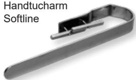
**Handtucharm Plawa Softline**, Zubehör zum seitlichen Überstreifen von Textilien, in beliebiger Anzahl und beliebiger Höhe links oder rechts positionierbar. In den Längen 450 und 550 mm, Höhe 40 mm und ca. 50 mm Tiefe von Vorderkante Heizkörper bis Außenkante Handtucharm. Montage vor Installation des Heizkörpers. Nachrüstbar nur bei demontiertem Plawa.
