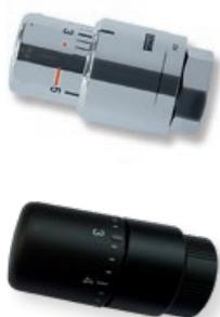
**Thermostat Puro**, eleganter, schlanker Design-Heizkörperregler, mit eingebautem Flüssigkeitselement, mit verchromter Griffhülse. Bei ungünstigen Lichtverhältnissen bzw. für Sehbehinderte kann die Grundeinstellung „3“ durch die ertastbaren Einstellhilfen leicht wiedergefunden werden. Für Ventilanschluss M30 x 1,5, Maße 75x42x42 mm (BxHxT). Minimalstellung: Nullstellung.
