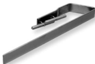
**Handtucharm Plawa Purline**, Zubehör zum seitlichen Überstreifen von Textilien, in beliebiger Anzahl und beliebiger Höhe links oder rechts positionierbar. In den Längen 475 und 575 mm, Höhe 40 mm und ca. 50 mm Tiefe von Vorderkante Heizkörper bis Außenkante Handtucharm. Montage vor Installation des Heizkörpers. Nachrüstbar nur bei demontierten Plawa.
