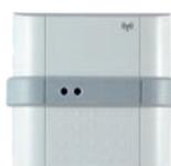
**Funk-Nachrüstset Economy Funk-Raumthermostat** digital, mit Ein-/ Aus-Schalter, Einstellbereich 5 - 35°C, IP30 inkl. 2 Batterien Typ AAA 1,5 V, Gehäuse weiss, Maße 83x80x27 mm (BxHxT), sowie **Funk-Empfänger**, zur Montage und Anschluss auf UP-Dose, Klasse 2, 230 VAC, max. Schaltleistung 16 A, IP20, Gehäuse weiss, Maße 87x87x20 mm (BxHxT). Passend zu Funk-Raumthermostat und Funk-Uhrenraumthermostat.
