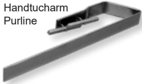
**Handtucharm Plawa Purline**, Zubehör zum seitlichen Überstreifen von Textilien, in beliebiger Anzahl und beliebiger Höhe links oder rechts positionierbar. In den Längen 475 und 575 mm, Höhe 40 mm und ca. 50 mm Tiefe von Vorderkante Heizkörper bis Außenkante Handtucharm. Montage vor Installation des Heizkörpers. Nachrüstbar nur bei demontiertem Plawa.
