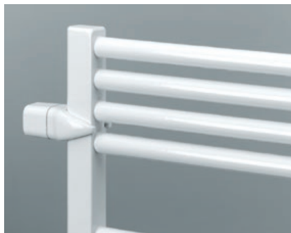
Mido und BMS Seitenkonsole Kurze Seitenkonsole 50 mm für raumsparende Montage. Lieferbar sind auch 120 und 200 mm Länge, z.B. um Fliesensockel zu überbrücken. Alle im Farbton des Heizkörpers.
