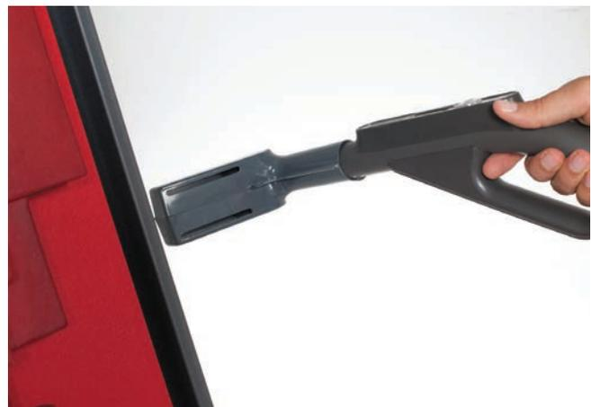
6.2 - Staubsaugeraufsatz mit den Öffnungsschlitzen nach vorne, hinter den Rahmen an die Filter führen.
