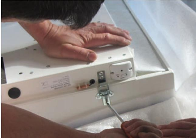
5.1 - Beide Sicherungsschrauben lösen.
