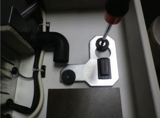
Die Pumpe auf die Fassung stecken und Anschlusskabel mit Stecker anschließen. Entlüftungs-Schlauch anschließen (im Lieferumfang der Pumpe) und mit Hilfe eines PVC-Schlauchs (nicht im Lieferumfang) 6 x 9 mm, die Verbindung zum Abfluss herstellen.
